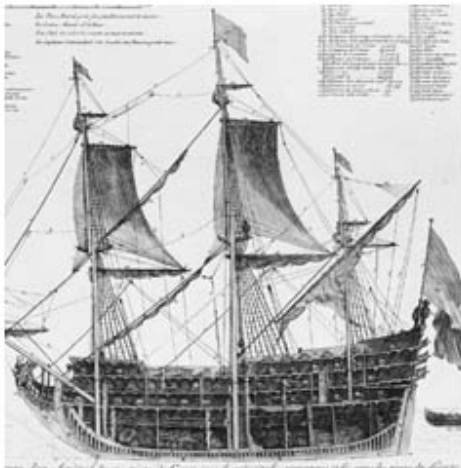
Coupe d'un amiral de 104 pièces de canon avec ses principales proportions et les noms des pièces du dedans, dans Le Neptune françois ou Atlas nouveau des cartes marines, par Pène, Cassini et autres, 1693. FR BNF Ge CC 1114, 1 ère partie, p. 7
